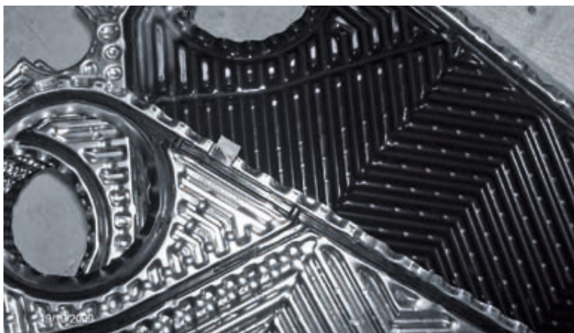
Центр изменения температуры: чем чище пластины, полости и промежуточные пространства, тем лучше циркулирует жидкость в теплообменнике.
